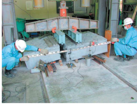
協会型中型積みブロック (基本 裏込めコンクリート150mm) 荷重条件：①
