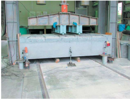
積みブロック (12A 裏込めコンクリート150mm) 荷重条件：①
