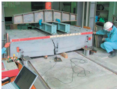
積みブロック (12A 裏込めコンクリート0mm) 荷重条件：②
