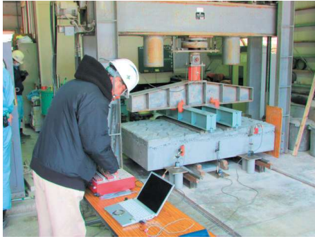
協会型中型積みブロック (基本 裏込めコンクリート150mm) 荷重条件：①
